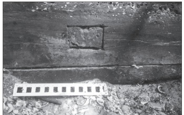
Fig. 3. Dor 2001/1. Details of keel and false keel (Photo: N. Sheizaf)
